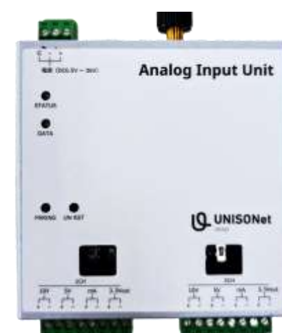
4-20mA/0-10V入力ユニット (騒音計, 距離計, pH計等と接続可)
